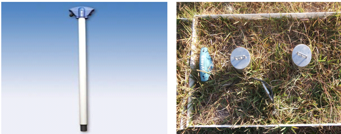
[그림 41] 고주파 정전용량식 토양수분센서(좌) 및 측기설치(우)
