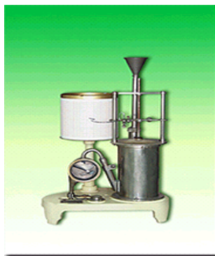
[그림 81] 사이펀식자기강수량계와 모식도
