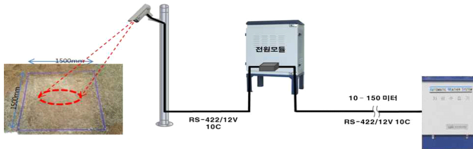
[그림 86] 적설계 시스템 구성
