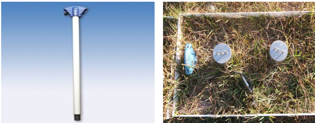
[그림 41] 고주파 정전용량식 토양수분센서(좌) 및 측기설치(우)
